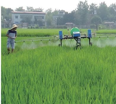
植保机器人在田间喷洒农药
