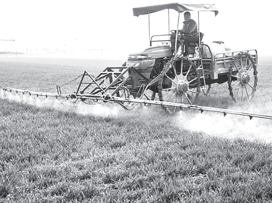
正在田间作业的“正阳牛”高地隙全自动四轮喷药机
